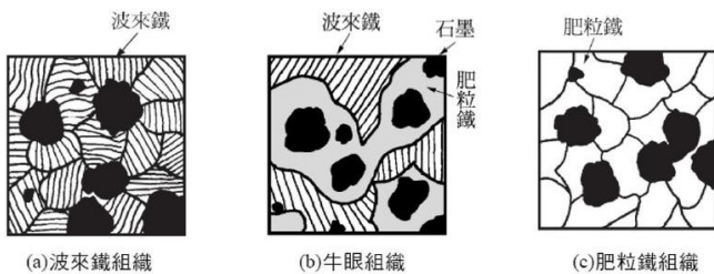
圖 8-16 延性鑄鐵的組織示意圖
